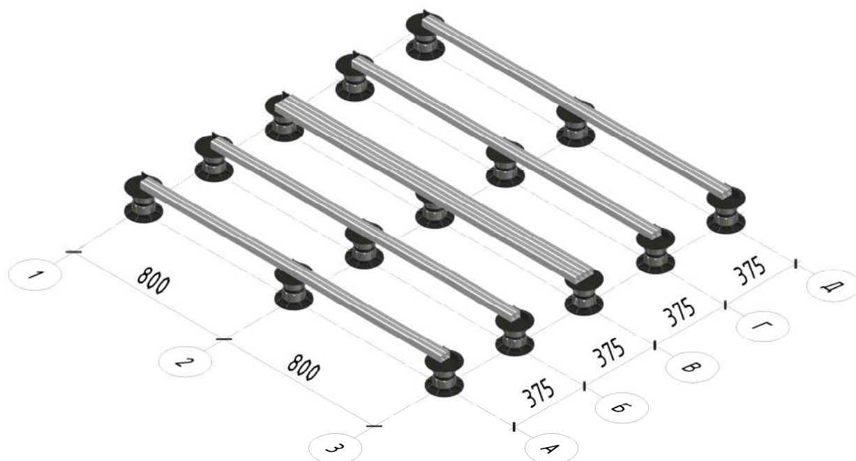
Рис. 4.2. Схема расположения регулируемых опор при использовании алюминиевой лаги 75
